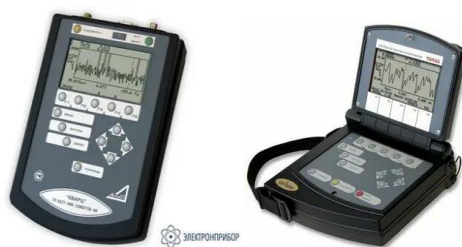
1.8 Сурет – Діріл анализаторлары, солдан оңға: "КВАРЦ", "ТОПАЗ"
